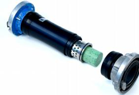
Konstrukce přiměšovače **zajišťuje efektivní a rovnoměrné rozpouštění kartuše**. Veškerá voda vstupující do přiměšovače se dostává v turbulentním proudění do kontaktu s kartuší a je ošetřena smáčedlem. Dostatečné děrování síta **minimalizuje tlakovou ztrátu** na přiměšovači a zároveň **zabraňuje ucpání** přiměšovače nečistotami při čerpání z přírodních zdrojů (jehličí, listí, písek, apod.).
